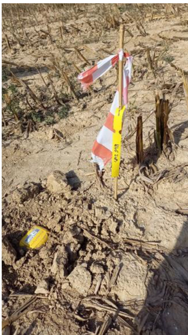
Slika 3. Bežični geofon (prijamnik) i njegova pozicija na terenu (označena geofonska točka)
